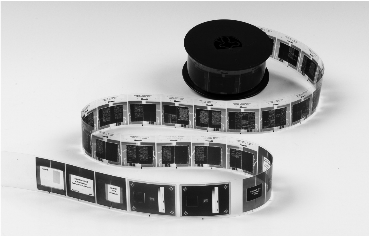
Der 35 mm-Schwarz-Weiß-Mikrofilm der Bundessicherungsverfilmung: Auf eine Metallspule passen 65 m dieses Polyester-Dünnbasisfilmes mit den Aufnahmen von rund 2000 Doppelseiten (Foto: Bayerisches Hauptstaatsarchiv).
